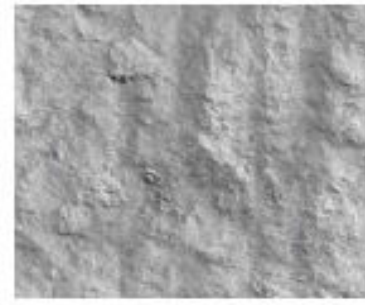
CSP 9 – Escarificação muito alta / plana média 5435,6 \mu\text{m}^*
