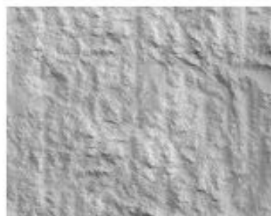
CSP 6 – Escarificação (fresa) média / jateamento médio-pesado 3175 \mu\text{m}^*
